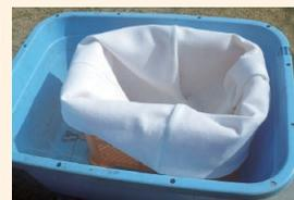
原水をためた簡易貯水槽にオイルロックスを投入してハンドミキサーでかき混ぜれば数分で凝集処理でき、簡単な濾過装置に通水させるだけで清澄な処理水が得られます。
